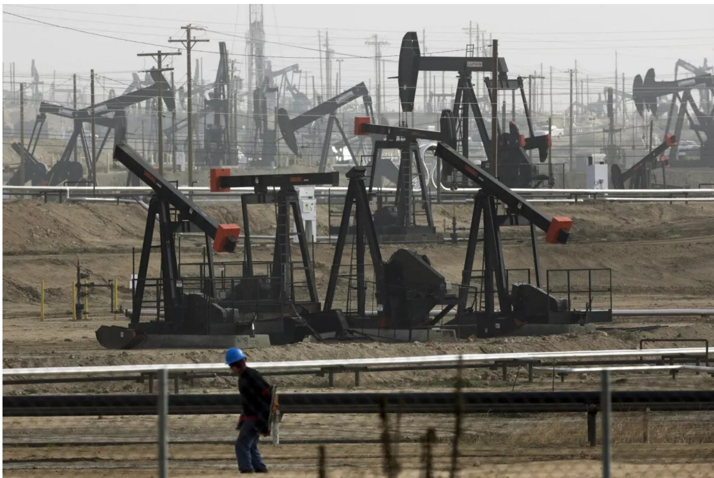
Des «pompes à tête de cheval» en fonctionnement sur le champ pétrolier de Kern River, à Bakersfield, en janvier 2015 (Associated Press)
