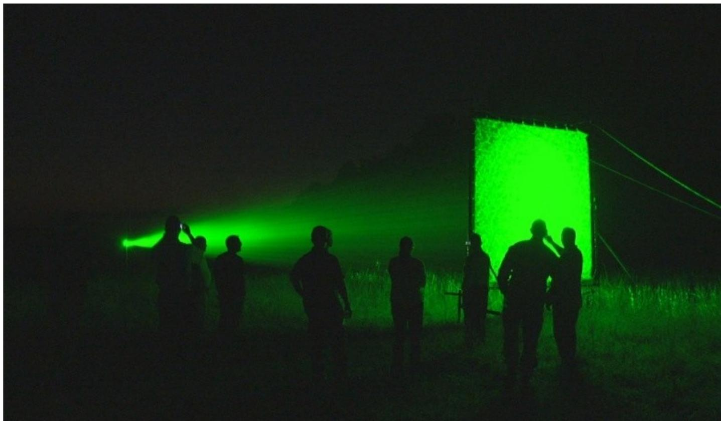
***Le projecteur Ocular à longue portée produit un effet d'avertissement à une distance de 3000 mètres et augmente la brillance du faisceau à une distance allant jusqu'à 2000 mètres pour assurer l'éblouissement de ce qui menace la cible. (DoD, Todd Getz)***
